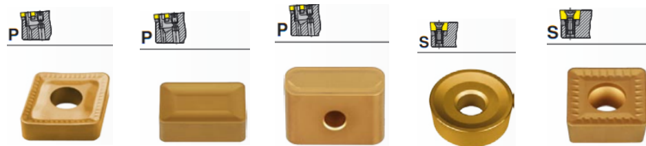
Рисунок 3- Пластини різальні (Pramet), що рекомендовані для обточування деталей на важких верстатах (рекомендовані подачі – 0,45–1,7 мм/об., глибина різання – 4–27 мм, швидкість різання – 135–250 м/хв.)
