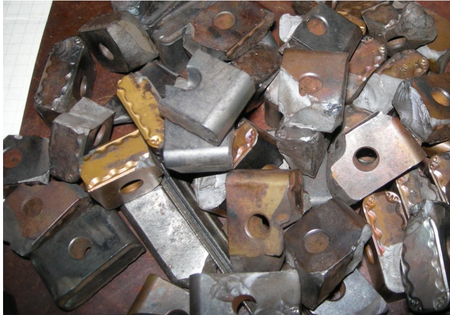
Рисунок 8- Списані тангенціальні пластини для важких верстатів, що досягли технологічного критерію відмови
